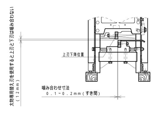
(注)刃の噛み合わせを行う時は必ず細物専用の替え刃を取り付けて行って下さい。 太物専用替え刃の場合は噛み合わない為、すき間の確認が出来ない
