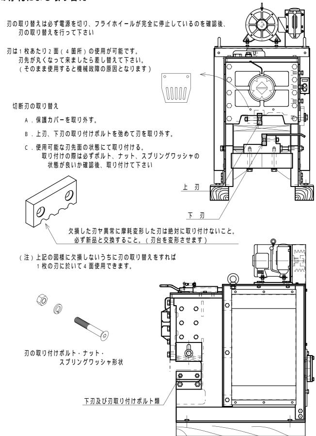
(注)ボルト、ナット、スプリングワッシャの不良及び刃先の欠損した物は絶対使用しないで下さい 欠損した状態で使用すると他の故障及び事故の原因になりますから新品のボルト類及び刃と取り替えて下さい
